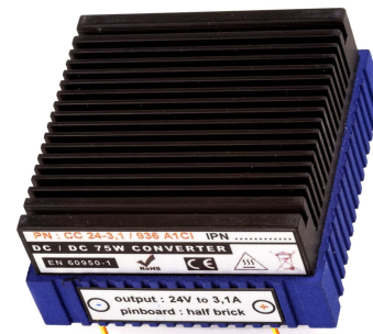
Boîtier A1CI 64 x 64 x 31mm, soudable sur circuit imprimé (implantation type "demi-brique", broches \varnothing 1mm )
