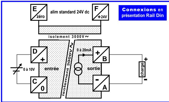
Ce mini-module à triple isolement (3000V~) convertit proportionnellement en "0 à 20mA", rapidement et avec précision, les signaux "0 à 10V" appliqués sur son entrée.
